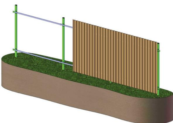
Для ограждений используйте стеновые профили C8A, C10A, В, C20A, В или фигурные версии этих профилей. Для увеличения жесткости забора допускается использовать профиль C21R.
